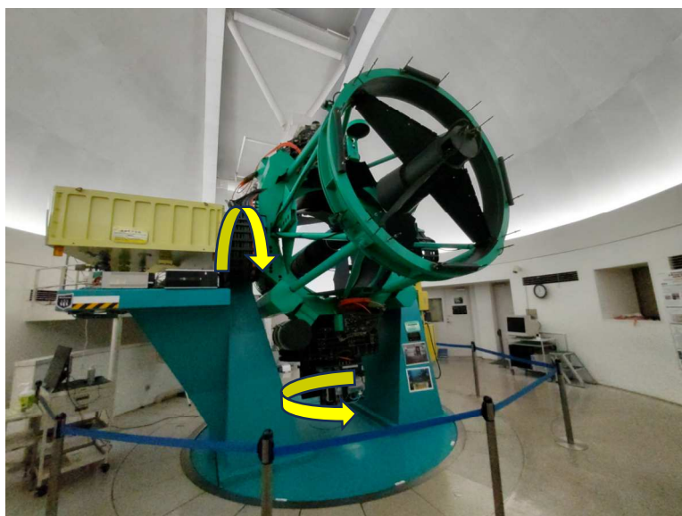
150 cm 望遠鏡：「経緯台式」（黄色矢印は回転可能部を示す）
